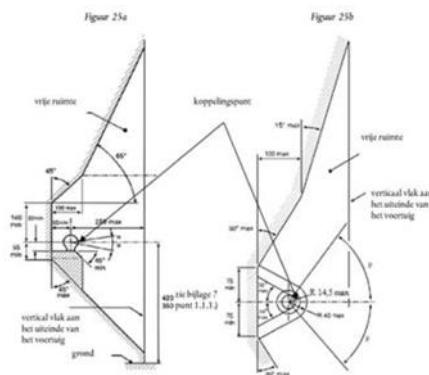
Um diesen Freiraum beim ziehen eines Anhängers in Kombination mit einem installierten Van 'n Bike Trägersystem einzuhalten, kann die Kugelkupplung am Van 'n Bike Trägersystem vorübergehend entfernt werden oder eine verlängerte Anhängerlkupplung an Ihrem Fahrzeugs eine Lösung bieten. Der
