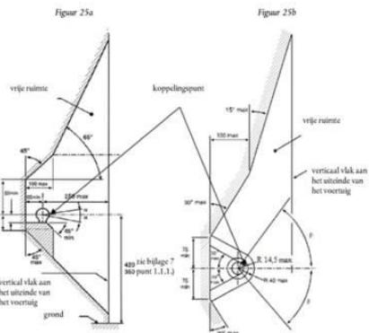
Pour obtenir cet espace libre lors du remorquage d'une remorque en combinaison avec un système de porte-vélos Van 'n Bike installé, l'attelage à boule du système de porte-vélos Van 'n Bike peut être temporairement retiré ou une barre de remorquage allongée sur le timon de votre véhicule peut offrir une solution. L'utilisateur doit s'adresser directement au fabricant de manière à ce que l'essentiel puisse être expliqué avec des instructions.
