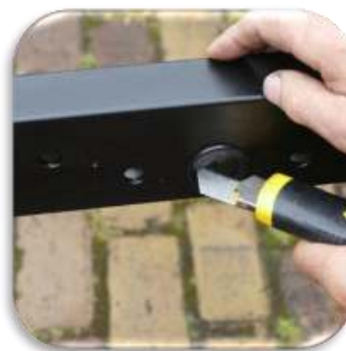
Serrez les boulons d'espacement sur ces vis attachées (2 par lampe)
