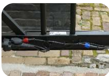
Fixez la fiche à 13 broches aux fiches des lampes. Le rouge est à droite, le bleu est à gauche.
