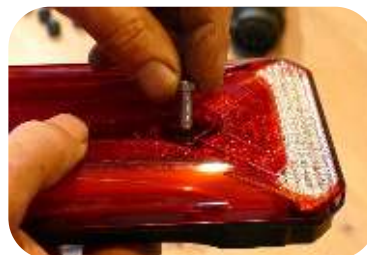
Insérez les vis dans le trou de la lampe (2 par lampe)
