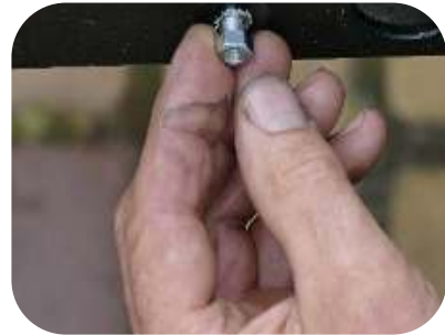
Visser le tout avec les écrous M6 (4 pièces) max 1 Newton.
