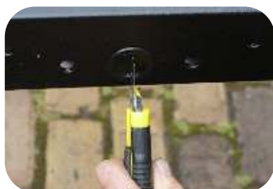
Faire une croix au couteau dans les 2 passages du tube horizontal inférieur.
