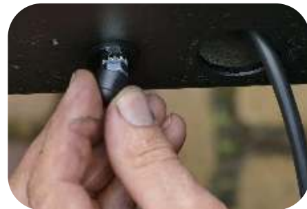
Placez les capuchons M6 sur les écrous.
